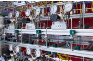
Heterogene Katalysator-Screeningstation für paralleles Katalysatorscreening unter definierten Bedingungen
