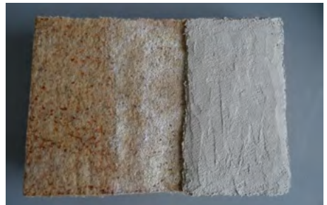
Modifizierte Wolldämmstoffplatte zur besseren Verputzbarkeit
