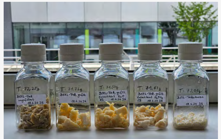
Unterschiedliche Raffinationsstufen des Insektenfetts für die Umsetzung zu Biotensiden. Von links nach rechts: gepresstes Rohfett, gefiltertes Fett, entschleimtes Fett, zweifach entschleimtes Fett, freie Fettsäuren
