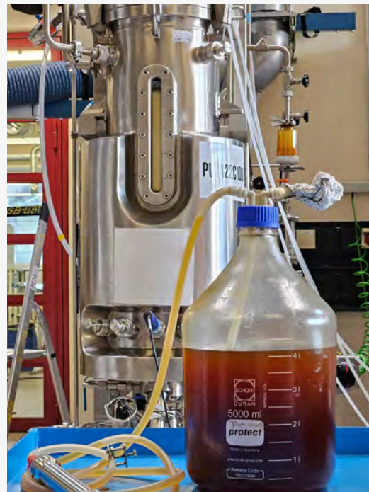
Fermentation von Insektenfett zum Biotensid MEL im Bioreaktor
